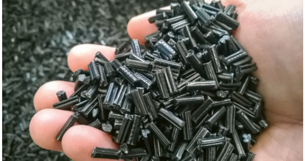
Recyclinggranulat aus Rahmen der DUO Universalschalung
