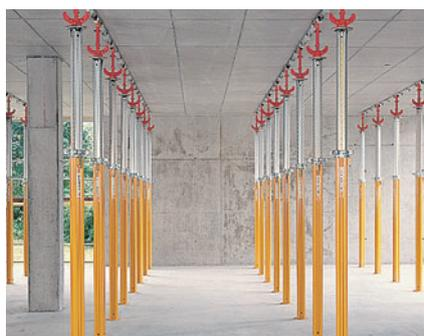
Når dækstøtten bruges med SKYDECK dækforskalling – vist her efter tidlig afforskalling – til et dækeareal på 3,45 m<sup>2</sup>, er der kun brug for 1 MULTIPROP støtte ved en dæktykkelse på op til 43 cm.
