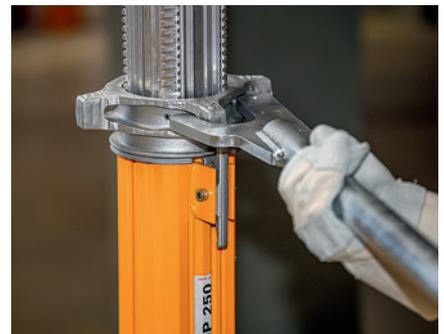
Med spindelnøglen HD kan en last over 60 kN spindles nemt uden belastning.
