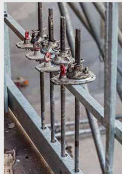
Du kan hænge ankrene direkte på gelænderet. Når en enhed er flyttet, kan den igen monteres.
