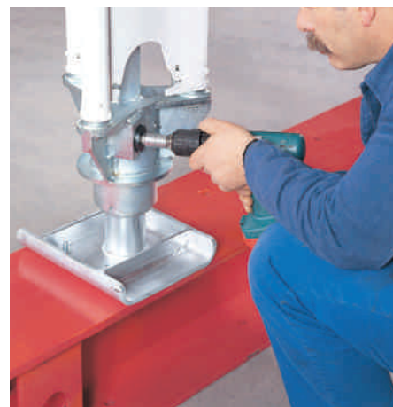
Sænkes med en almindelig boremaskine SW 19. (slagbor må ikke anvendes)
