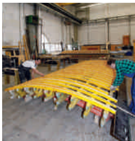
Montage af GRV forme med segmenterede spanter.
